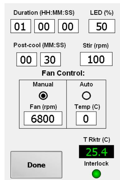
如需更改给定参数的设定值，请在触摸屏上选择。您所选参数将相应地如右图所示显示。可以旋转表盘来选择所需的设置。或者，用户也可按下“KEY”（键）按钮进而输入确切数值。按下“DONE”（完成）按钮则接受该数值。
